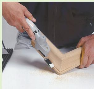
曲面加工(自由加工パッド使用) コーナー仕上(三角パッド使用) 凸端面仕上(クランクパッド使用)
